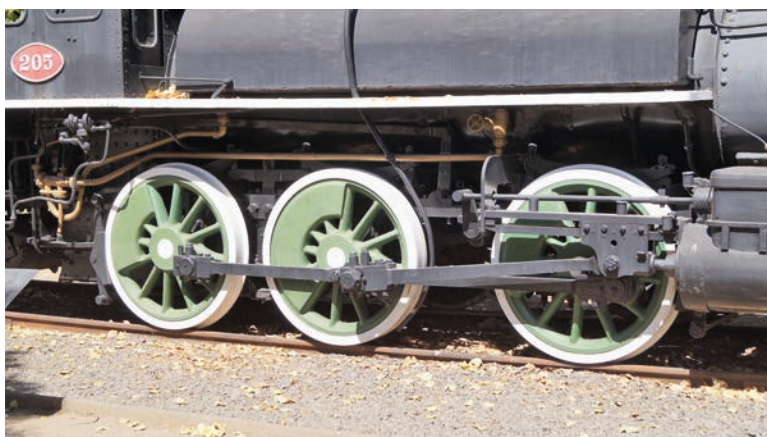
Disposición de las ruedas, locomotora N°205 0-6-0 T
