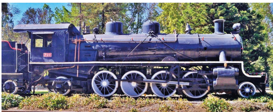
Disposición de las ruedas de la locomotora N° 709 2-8-2
