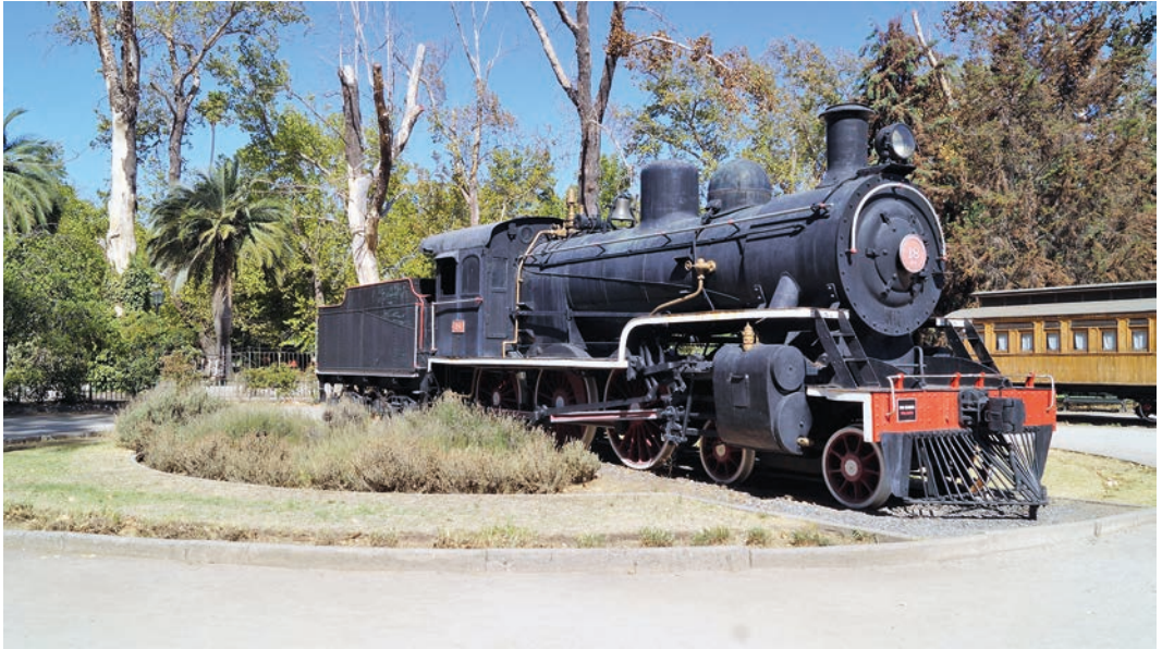
Disposición de las ruedas de la locomotora N° 18 4-6-0
