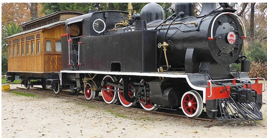
Disposición de las ruedas locomotora N° 3045 2-6-2
