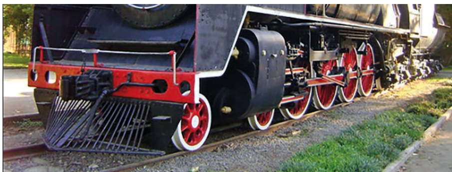
Disposición de las ruedas locomotora N°1009 4-8-4
