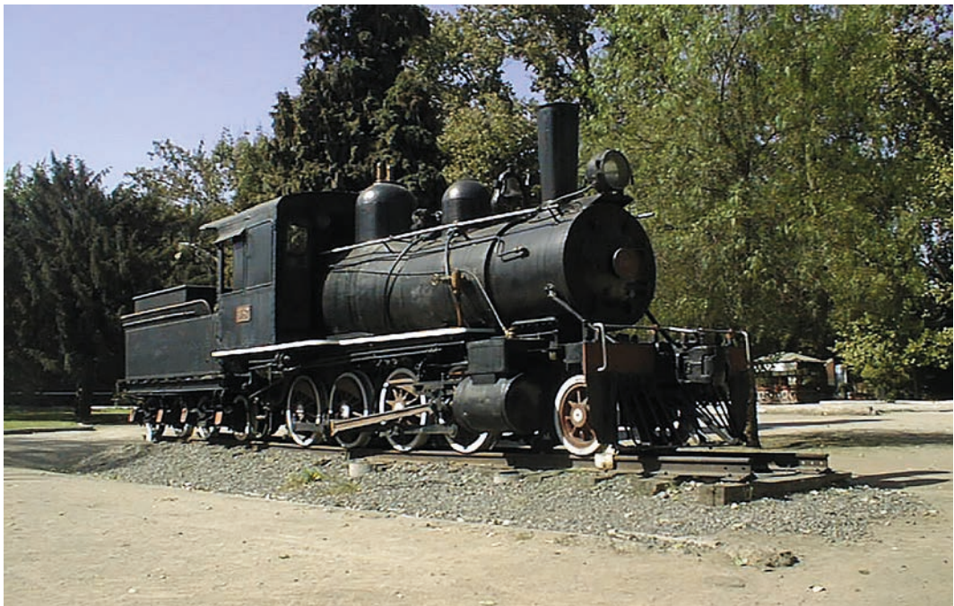
Disposición de las ruedas, locomotora N°3087 2-8-0
